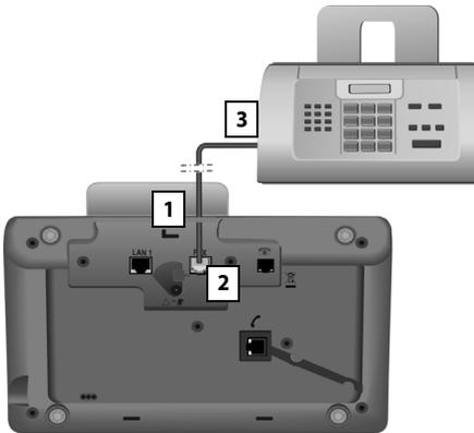
1. Führen Sie ein Ende des Fax-Anschlusskabels von hinten durch die Aussparung im Gehäuse.
