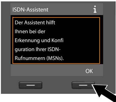
► Drücken Sie auf die Display-Taste **OK**, um die automatische MSN-Ermittlung zu starten. Das dauert einige Zeit.
