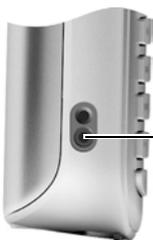
Nach Entfernen der Kunststoffabdeckung können Sie ein Headset mit 2,5 mm Klinkenstecker an der linken Seite Ihres Mobilteils anschließen. Empfehlungen zu Headsets finden Sie auf der jeweiligen Produktseite unter [www.gigaset.com](http://www.gigaset.com).
