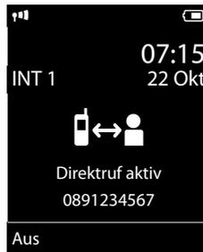
Beim Drücken einer beliebigen Taste wird die gespeicherte Nummer gewählt. Drücken Sie die Auflegen-Taste
